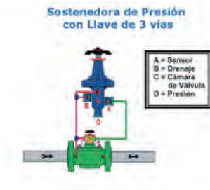
Conexión de Piloto Sostenedor + Piloto Regulador en Válvula con llave de 3 vías
