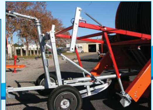
Relevage hydraulique couplé avec relevage des bèches
