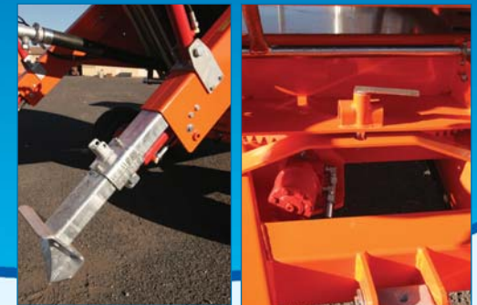
Bêches et rotation tourelle hydrauliques
